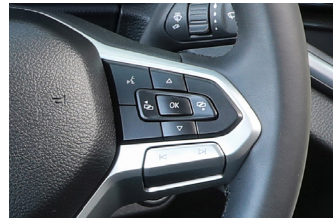
Botons de control per al quadre d'instruments digital a la dreta del volant multifuncional (la il·lustració mostra la línia d'equipament Aventura)
