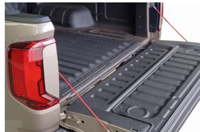
Interior de la porta gran posterior amb superfície funcional.
