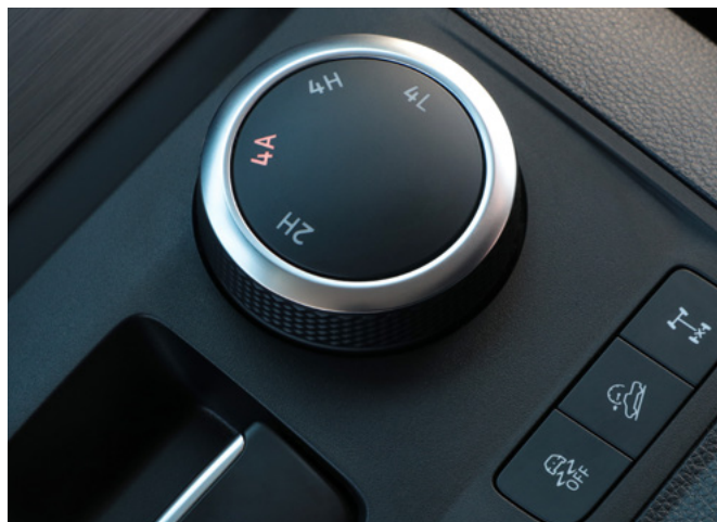
Commutador de tracció integral connectable 4MOTION i botó de bloqueig del diferencial (dreta) a la consola central.
